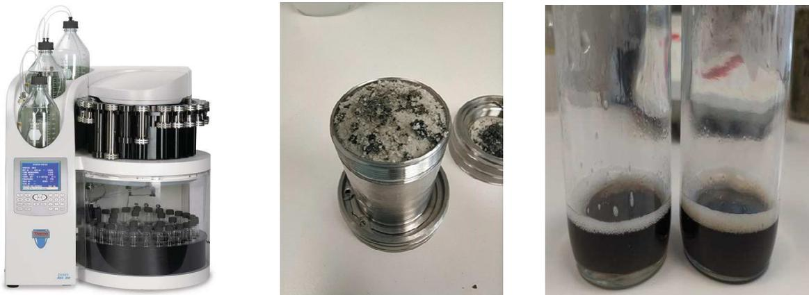
**Figure 2 – Dans l'ordre de droite à gauche : Le système d'extraction accéléré par solvant Thermo Scientific™ Dionex™ ASE™ 350, une cellule 50/50 plante terre diatomée, l'extrait hydroalcoolique 8/2 de feuilles.**
