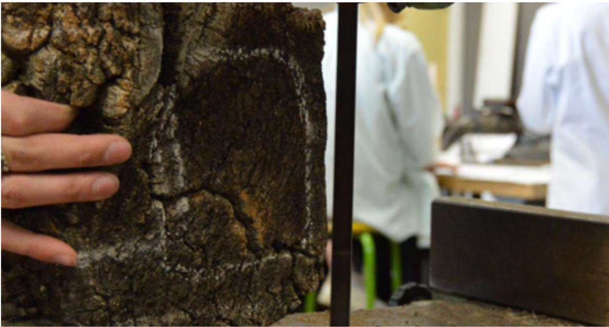
Découpage des bouchons dans des morceaux de liège brut
