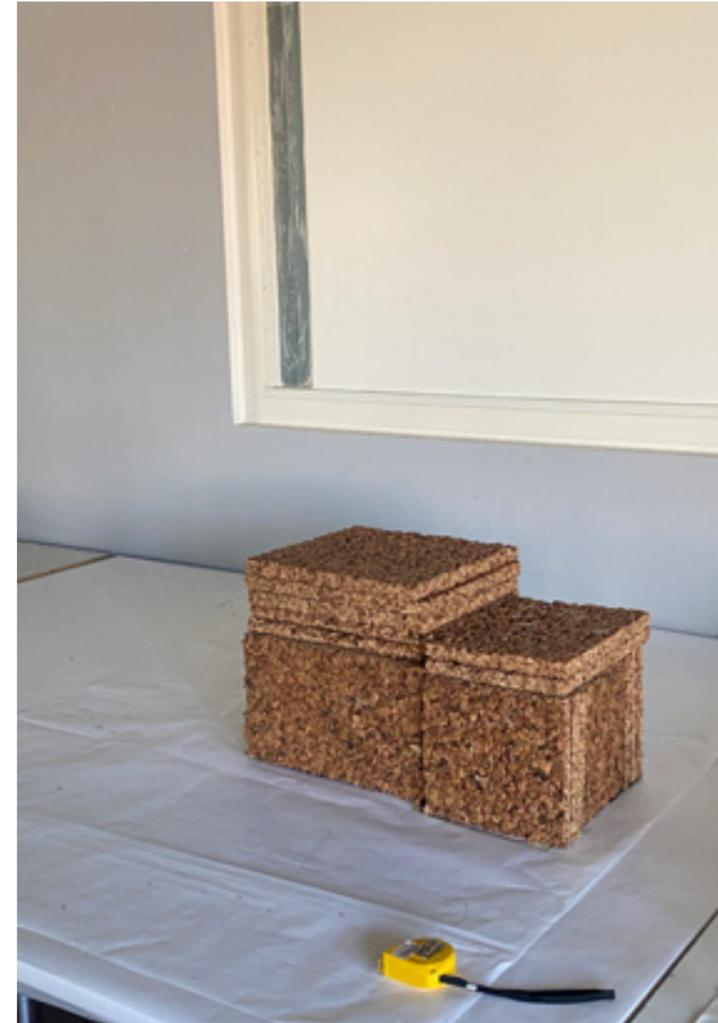
Assemblage par plaques d'agglomérées de liège
