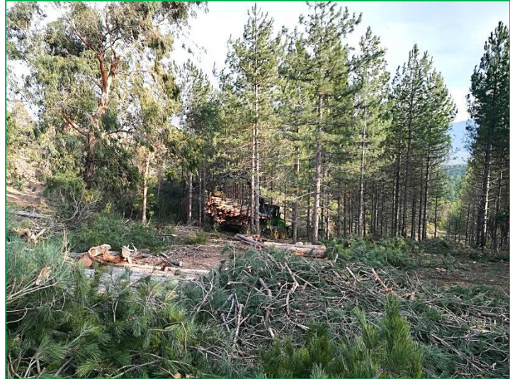
Porteur forestier dans un cloisonnement récoltant le bois abattu
