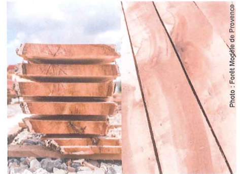
Essais de sciage de bois de chêne-liège.
