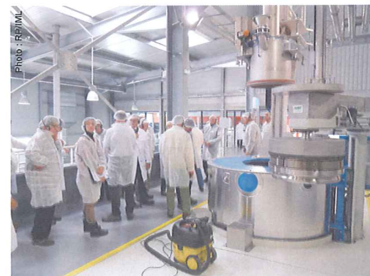
Partie supérieure des immenses autoclaves (10 m de hauteur !), où se fait le remplissage par la farine de liège.
