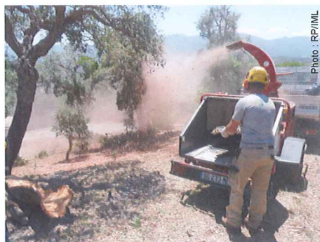
Broyage du liège dans un broyeur à marteau pour branches et végétaux
