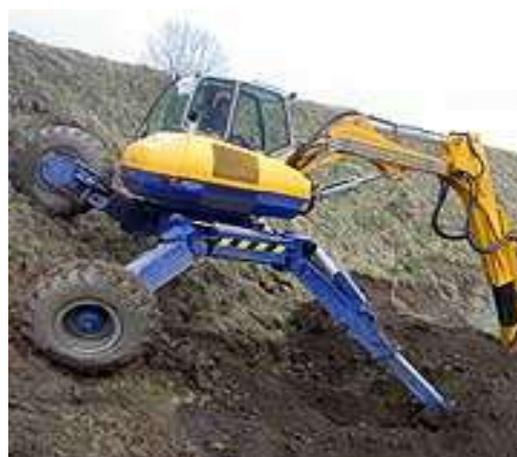
Figure 10 - Utilisation de pelle-araignée en terrain pentu.
